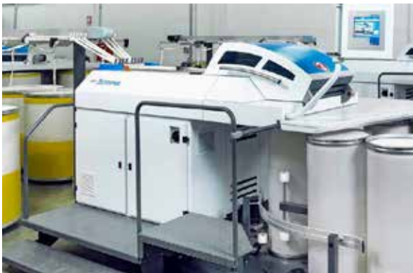
Manuar Trutzschler TD-8, con búsqueda automática del autorregulado y modificación electrónica del pre-estiraje.
