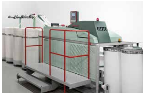
Manuar Rieter RSB-D45, con búsqueda automática del autorregulado, modificación instantánea de los ecartamientos, control de tensiones, guiado y geometría exacta.
